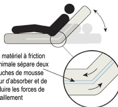
Un matériel à friction minimale sépare deux couches de mousse pour d'absorber et de réduire les forces de cisaillement
